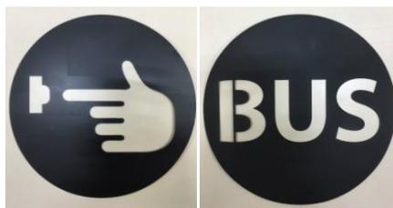
\*Pictogramas realizados en chapa de acero cortada a láser e instalada interiormente entre las dos lentes que configuran el sistema *high flux*, lo que garantiza la integridad del pictograma durante toda la vida útil del semáforo sin ningún tipo de mantenimiento.
